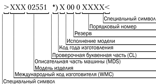
Рисунок 2.4 — Маркировочная табличка машины и расшифровка идентификационного номера харвестера АМКОДОР 2551
