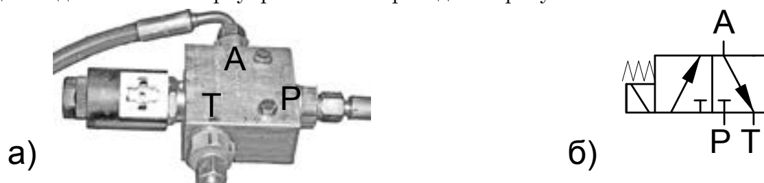
Рисунок 3.73 — Клапан электроуправляемый: а) общий вид; б) принципиальная схема
