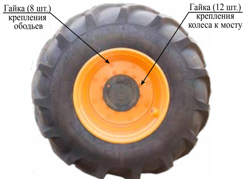
Рисунок 3.32 — Схема затяжки гаек крепления ободьев передних колёс
